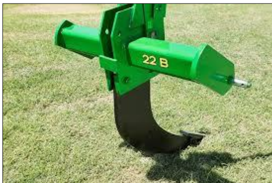
Subsolador o Ripper, de uno y de dos brazos respectivamente.
